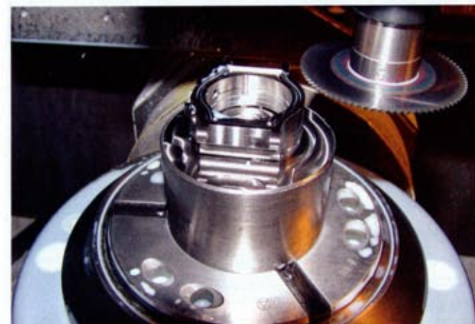
Die aus Stangenmaterial gefräste Uhrenschale in der MC 531/M.
