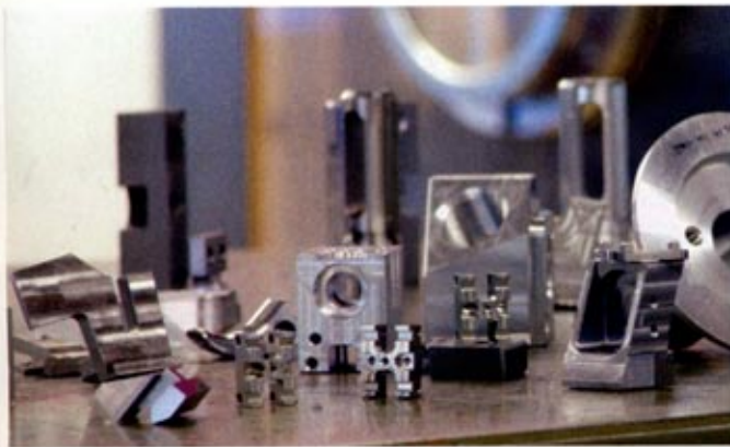
Diverse Fräs-/Drehteile, welche auf der Stama MC 351/M bei der Distec AG gefertigt werden.
